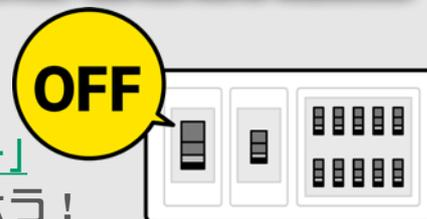
地震による電気火災を防ぐには、「感震ブレーカー」の設置が有効です。
