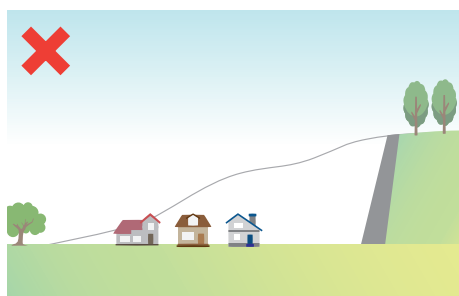
従来の地形を極端に削り、 巨大な擁壁が生じてしまっている
