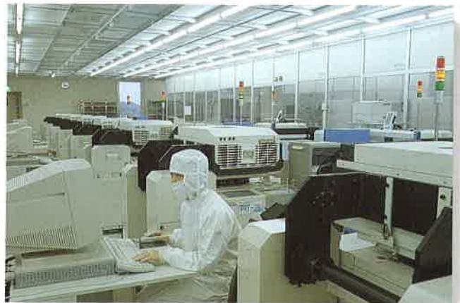
半導体の製品の機械による検査
