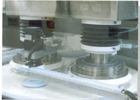
半導体の原材料（ウエハー）の研磨
