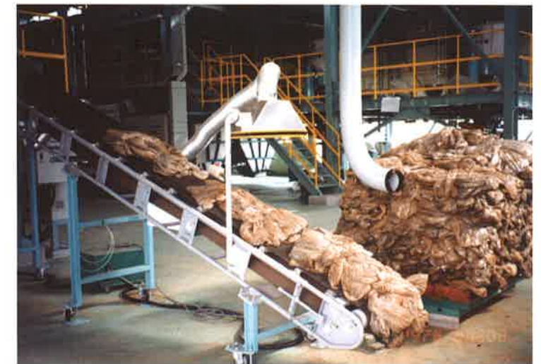
⑮ 農業用廃ビニール（原料）の投入
