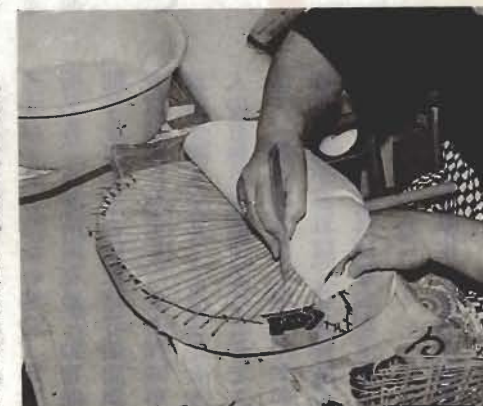
24工程の1つ、貼りの工程
