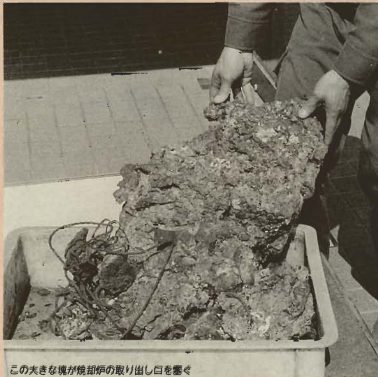
この大きな塊が焼却炉の取り出し口を塞ぐ
