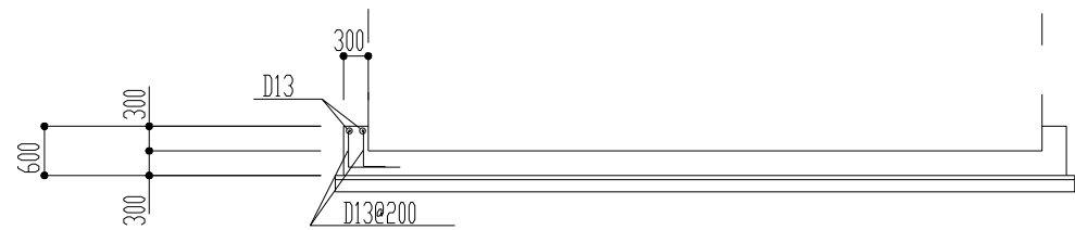
処理槽基礎配筋平面図 1/50
