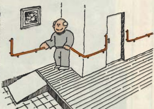
段差をなくすスロープや廊下の手すり
